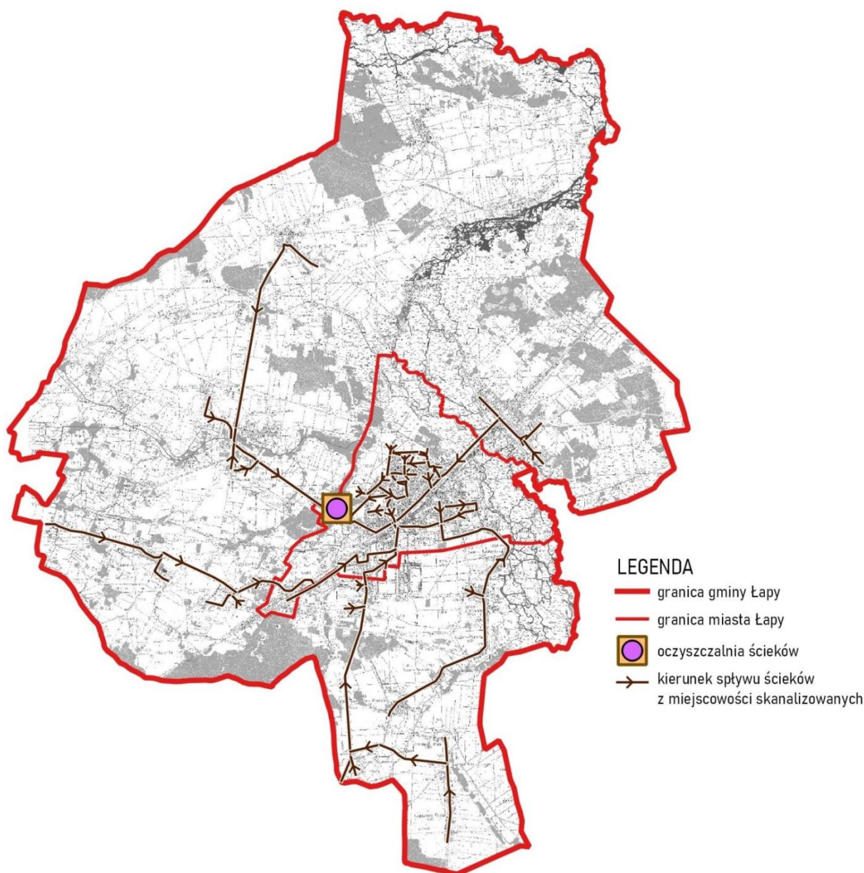
Rycina nr 18. Schemat istniejącej sieci kanalizacyjnej
